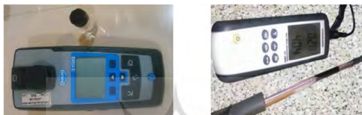
شکل ۴: دستگاه سرعت‌سنج باد ( سمت راست) و دستگاه کدورت‌سنج (سمت چپ)
