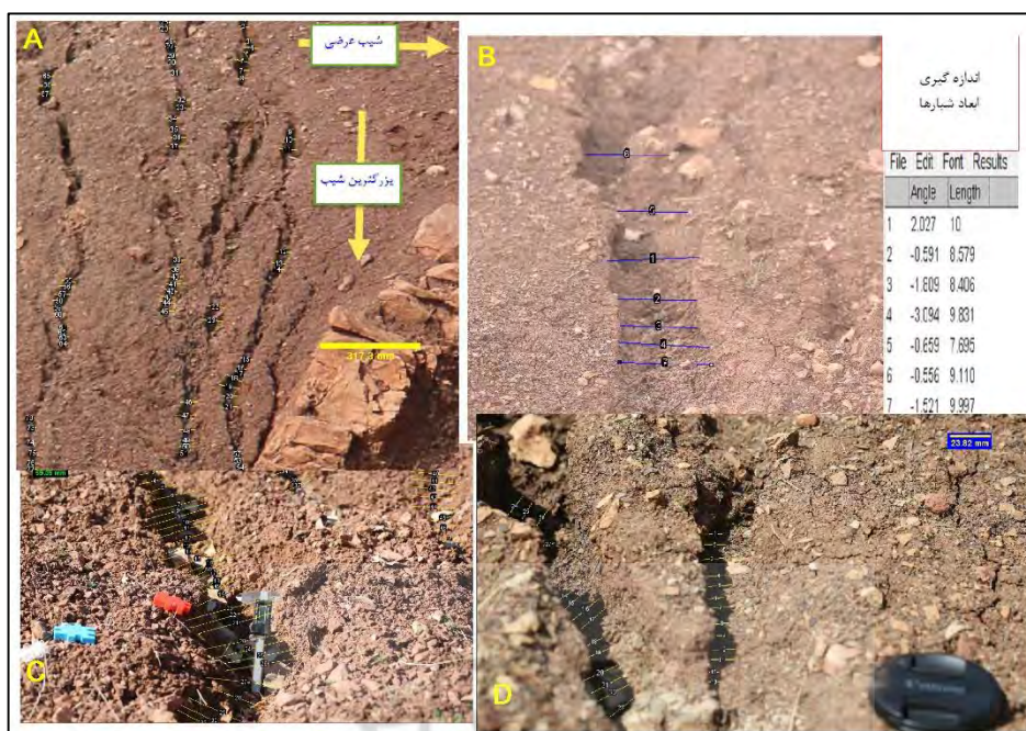
شکل ۳. نمونه از تحلیل‌های تصویری و استخراج اطلاعات از تصاویر میدانی: مقیاس گذاری، استخراج ویژگی‌های پهنا و طول سایه فرسایش شیاری؛ تصویر A رسم ترانسکت در عرض شیاریها، تصویر B مقاطع عرضی شیاریها به همراه اطلاعات خروجی؛ تصویر C اندازه‌گیری سایه و ارتفاع دیواره در صحرا با کولیس و مقایسه آن با ارتفاع دیواره شیاریها؛ تصویر D محاسبه سایه روی تصویر
