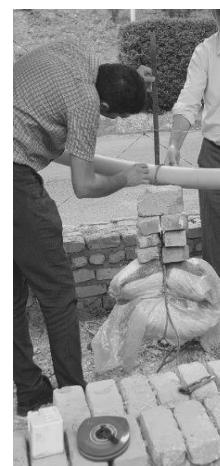
ت ۱۰. بارگذاری ۵۶ کیلویی لوله ۹۰ فشار نیمه‌قوی.
