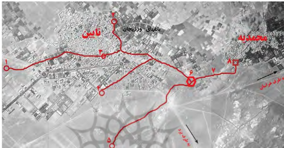
1. مسیر آج مهریجان 2. مسیر آج گر شاخه 1 دروازه پنجاهه 3. مسیر آج گر شاخه 2 دروازه چهل دختران 4. مسیر آج گرم شاخه مصلی 5. مسیر آج گرم 6. محل متصل شدن سه آج و یک شاخه شدن قنات 7. مسیر یکپارچه سه آج قنات تا مظهر 8. مظهر قنات در باغ حاج سید محمدعلی
