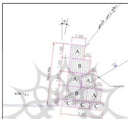
ت 13. جزئیات اجرای دیوار گابیونی در حاشیه رودخانه.
