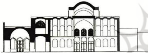
۲. نوع پوشش فضایی چهارصفه به وسیله چهارتاقی در خانه سلامتی. مأخذ: غفاری، ۱۳۷۹.
