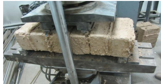
ت ۱۶. آزمایش خمشی بر روی نمونه‌های منشوری ساخته با ۶ ردیف خشت
