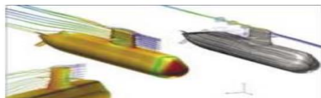
شکل (۲) فرم مناسب هیدرودینامیکی بدنه و پروانه کم نویز
