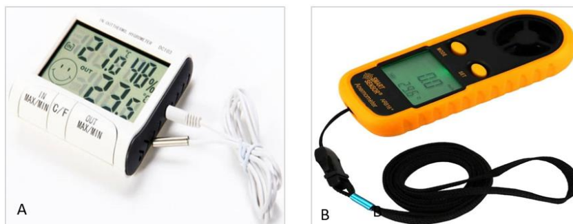
شکل ۲. دستگاه‌های مورد استفاده برای اندازه‌گیری (A) دما و رطوبت (مدل DC103) و (B) سرعت جریان هوا (فلومتر AR816).
