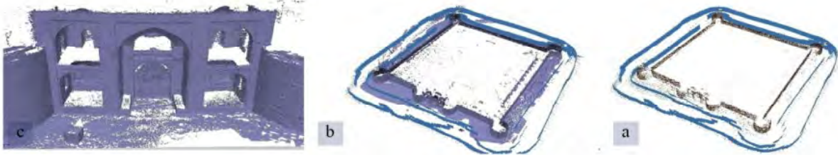
تصویر ۱۱- پردازش داده‌های مربوطه به جداره خارجی اثر، a: تعیین موقعیت تصاویر و تولید ابرنقطه پراکنده، b: تولید ابرنقطه متراکم، c: ابرنقطه متراکم، دید از سردر ورودی.
