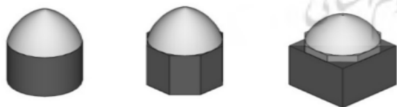
تصویر ۲- انواع گنبدخانه با بدنه مربع، چندضلعی و دایره.
