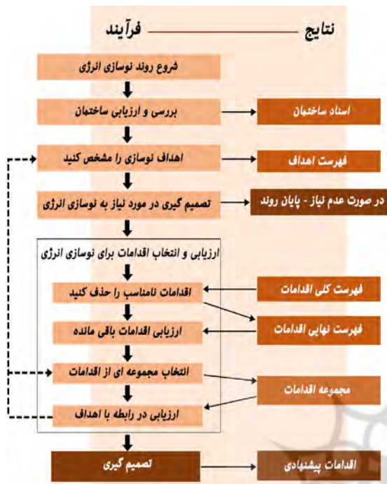
تصویر ۳- روندنمای روش پیشنهادی استاندارد اروپایی برای اقدامات نوسازی انرژی. مأخذ: (Technical Committee CEN/TC 346, 2015, 18)
