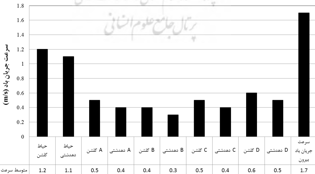
تصویر ۱۰- مقایسه ی متوسط سرعت جریان باد اندازه گیری شده در عمارت های دهدشتی و گلشن در روزهای آزمون، ۱۳۹۵.
