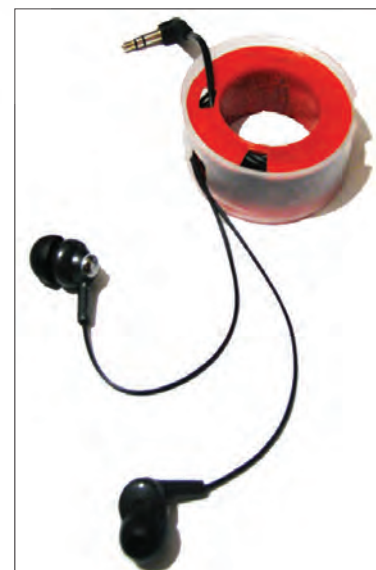
شکل ۳ و ۴ - نمونه یک: ساخت سیم جمع کن برای هدفون که با ایجاد شکاف در حلقه پلاستیکی نوار چسب ایجاد شده است.
