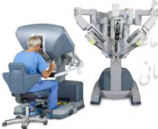
تصویر ۲- ربات جراحی با نام سیستم جراحی داوینچی، محصول شرکت Intuitive. مأخذ: (URL1)
