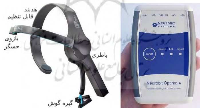
تصویر ۶- راست: ابزار ثبت فعالیت الکتریکی پوست، ضربان قلب و تنفس (شرکت Neurobit)، چپ: هدست ثبت فعالیت مغز (شرکت NeuroSky).
