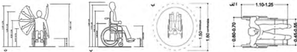
شکل ۲. الف: پلان صندلی چرخدار، ب: حوزه دسترسی افقی فرد معلول، پ: ابعاد فرد استفاده‌کننده از ویلچر، ت: حوزه دسترسی عمودی معلول، مأخذ: [۲۲]
