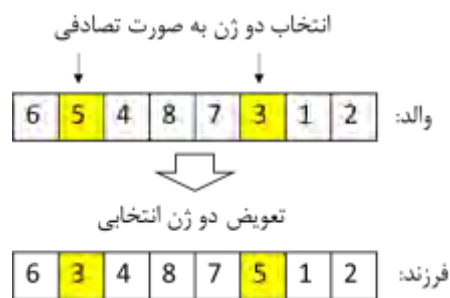
شکل ۹- عملگر جهش الگوریتم ژنتیک مبتنی بر اولویت Fig.9 – Mutation operator of priority-based method
