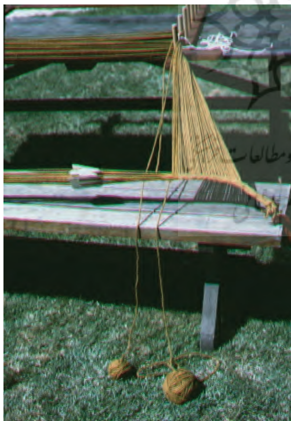
تصویر ۲. چله‌کشی نخ‌های تار با روش لوحه‌بافی (نگارندگان)
