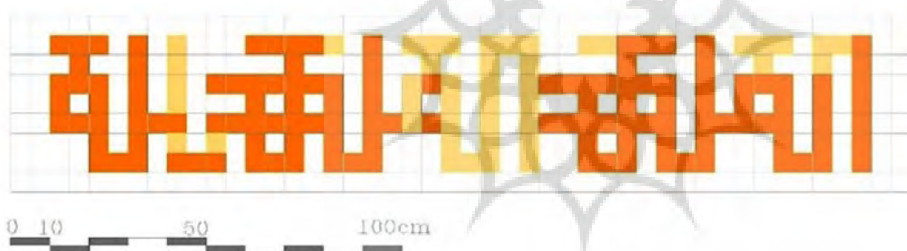
تصویر ۸: کتیبه آجرکاری بخش فوقانی برج جنوب شرقی. بخش‌های نارنجی‌رنگ موجود و بخش زردرنگ بازسازی تصویری شده‌اند.
