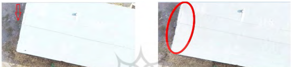
نگاره ۹: نمونه‌ای از ارتوفتو و نواقص در لبه ساختمان‌ها، الف) AgisMesh، ب) Pix4D
