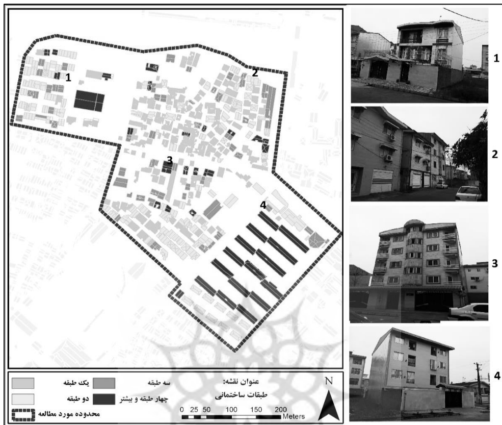
شکل ۱۵. استخراج طبقات هریک از ساختمان‌ها
