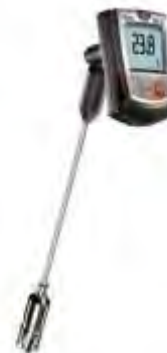
شکل ۳: به ترتیب از راست به چپ، دماسنج سطحی Testo 905-T2، دماسنج و رطوبت سنج Datalogger. (منبع: نگارندگان، ۱۴۰۰)
