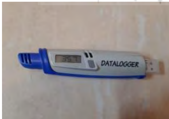
شکل ۳: به ترتیب از راست به چپ، دماسنج سطحی Testo 905-T2، دماسنج و رطوبت سنج Datalogger. (منبع: نگارندگان، ۱۴۰۰)
