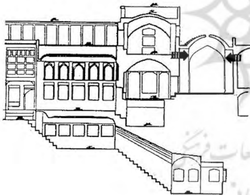
پلان ۳: نحوه استقرار بنا روی خاک جلو و ساباط‌ها (ماخذ: نگارنده، ۱۳۹۹)
