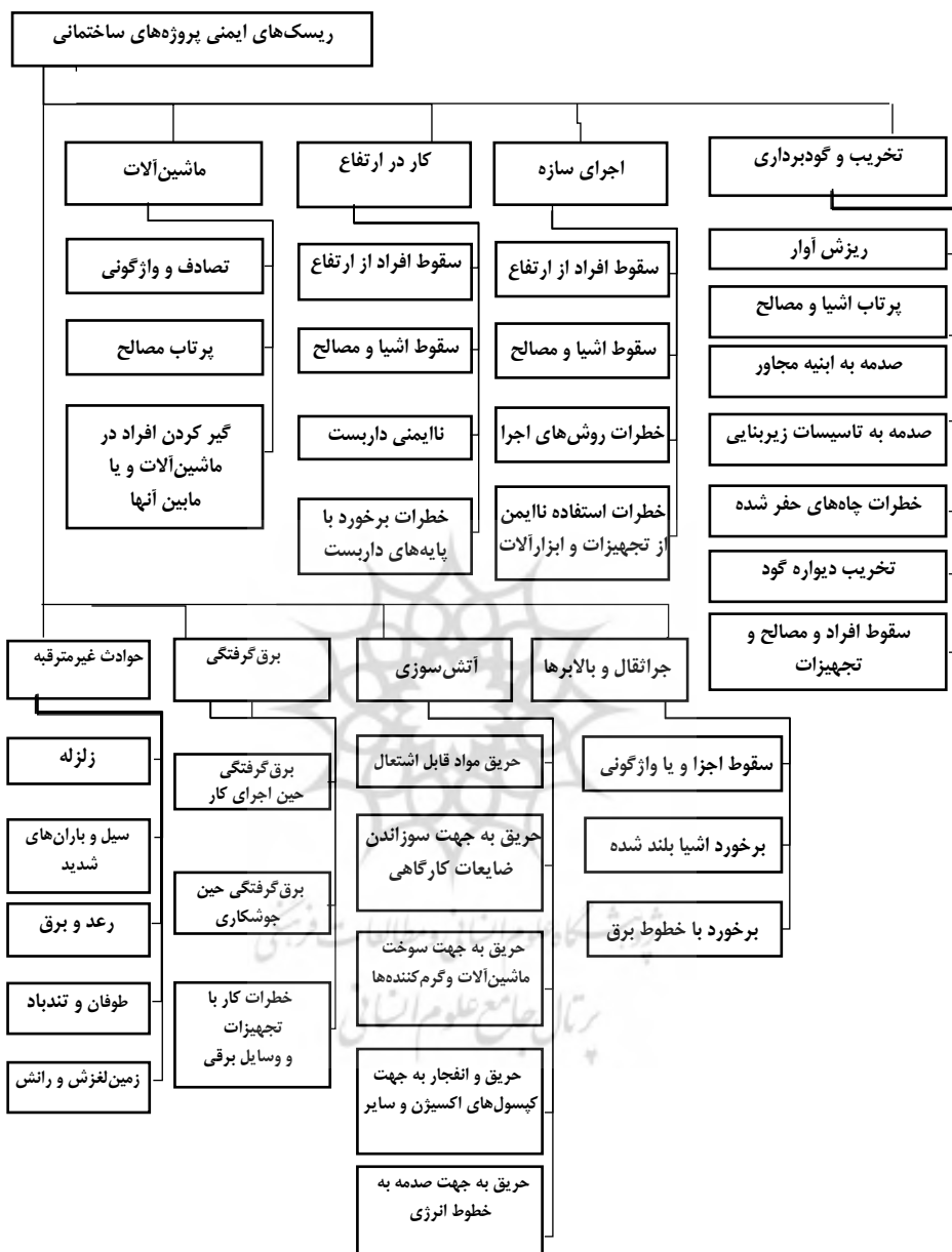
شکل شماره ۲: نمودار ساختار شکست ریسک‌های ایمنی پروژه‌های ساختمانی Figure 2: Failure Structure of safety risks of construction projects
