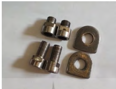
شکل ۲- واشر و پیچ‌های ساخته شده برای افزایش عرض رکاب
