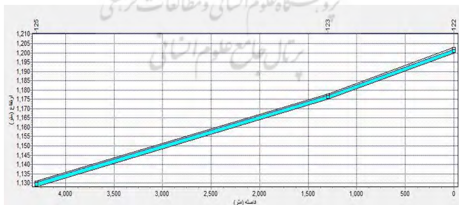
شکل ۸: پروفیل طولی ظرفیت کانال ۱۷ شهریور در دوره بازگشت ۱۰۰ سال در وضعیت مطلوب
