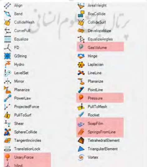
شکل ۶- چند نمونه از نیروهای قابل اعمال بر سازه ها در افزونه کانگورو (مأخذ: نگارندگان، ۱۴۰۰)
