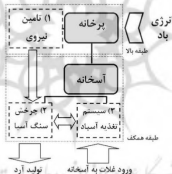
شکل ۹- مکانیزم و طرز کار آسباد ها ( منبع : غلامی و همکاران، ۱۳۹۶)
