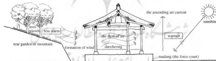
شکل ۱۳- ایده تهویه در هانوک توسط جریان همرفتی در تابستان (ماخذ: کیم، ۲۰۰۶)
