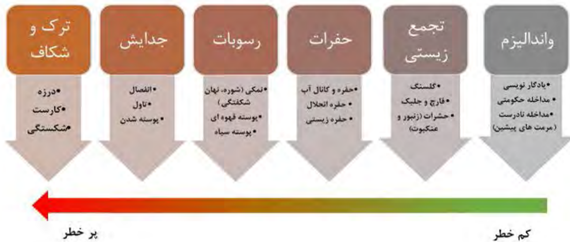
شکل ۲۱. الگوهای تخریب در محوطه تاریخی- فرهنگی تاق‌بستان به ترتیب از کم خطر تا پرخطر.
