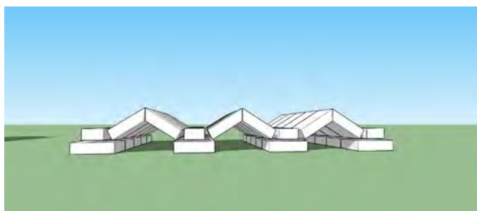
شکل ۱۲. اجرای لاپوش یک رج (محلّه فهادان یزد) به همراه مدل سه بعدی آن منبع: نویسندگان
