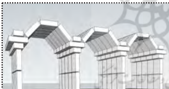
شکل ۷. استفاده از آجر تیغه در اجرای دیوار قید (محلۀ زرتشتیان یزد) به همراه مدل سه‌بعدی آن منبع: نگارندگان
