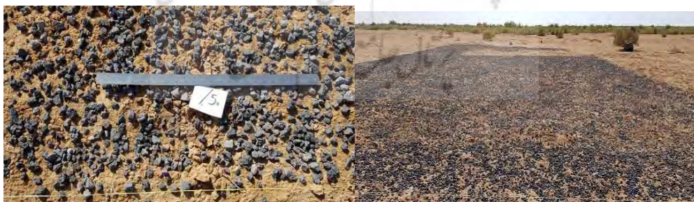
شکل ۲- تصاویری از پیاده سازی طرح و پاشش سربراره های فولاد مبارکه با تراکم های مختلف
