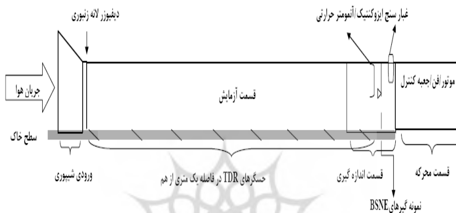
شکل ۲- نحوه نصب سیستم شبیه‌ساز در مکان‌های مورد آزمایش
