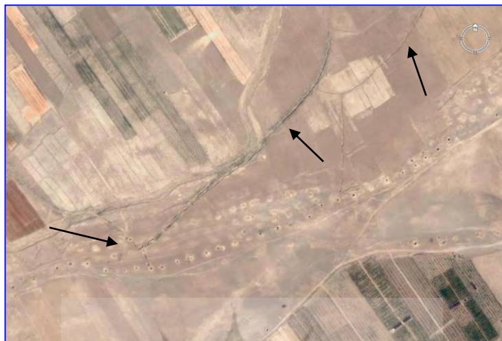
شکل ۷. شکاف‌های ناشی از فرونشینی سطح دشت.
