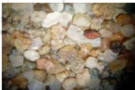
شکل ۷-۷: نمای کلی ماسه‌های ۵۰۰-۱۰۰۰ میکرونی
