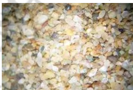
شکل ۵-۷: نمای کلی ماسه‌های ۲۵۰-۵۰۰ میکرونی
