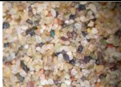
شکل ۱-۶. نمای کلی ماسه‌های ۱۲۵-۶۳ میکرونی
