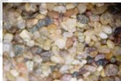
شکل ۵-۶. نمای کلی ماسه‌های ۵۰۰-۲۵۰ میکرونی
