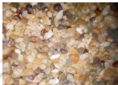
شکل ۳-۶. نمای کلی ماسه‌های ۱۲۵-۲۵۰ میکرونی
