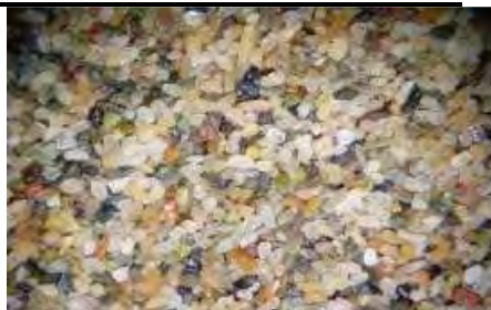
شکل ۱-۷: نمای کلی ماسه‌های ۶۳-۱۲۵ میکرونی
