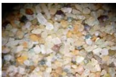
شکل ۳-۷: نمای کلی ماسه‌های ۱۲۵-۲۵۰ میکرونی
