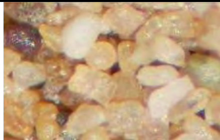
شکل ۲-۶. بزرگنمایی ۵ برابر از ماسه‌های ۱۲۵-۶۳ میکرونی
