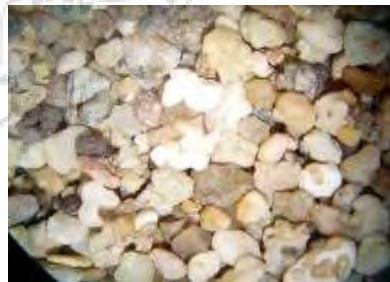
شکل ۷-۶. نمای کلی ماسه‌های ۱۰۰۰-۵۰۰ میکرونی
