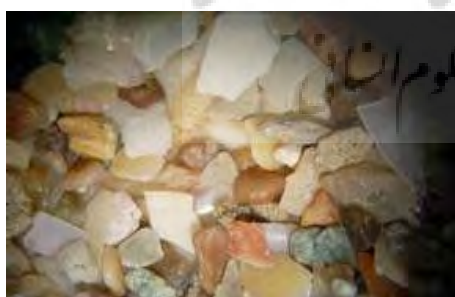
شکل ۸-۷: بزرگنمایی ۲ برابر از ماسه‌های ۵۰۰-۱۰۰۰ میکرونی
