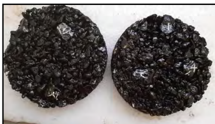
تصویر ۹- نمونه‌ای از نمونه‌های ۱۵ سانتی‌متر آسفالتی
