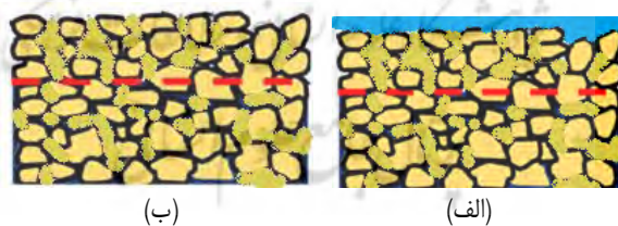
تصویر ۶- الف- عدم نفوذ قطرات باران در آسفالت معمولی نفوذناپذیر و ایجاد رواناب ب- عدم ایجاد تبخیر در آسفالت معمولی نفوذناپذیر به علت عدم موجود منافذ
