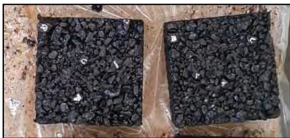
تصویر ۸- نمونه‌ای از نمونه‌های مکعبی آسفالتی
