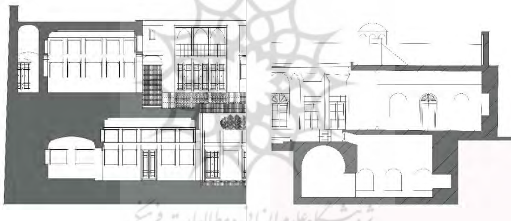
تصویر ۱- راست: مقطع فضای زیرزمینی زیر هفت دری (زمستان نشین) خانه رسولیان (دانشکده هنر و معماری دانشگاه یزد) تصویر ۱- چپ: مقطع گودال باغچه خانه لاری‌ها (دانشکده هنر و معماری دانشگاه یزد)
