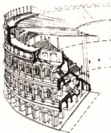
تصویر ۱۴- پوشش باز و بسته‌شونده برای کلیزه رم (ماخذ: Friedman, 2011)
