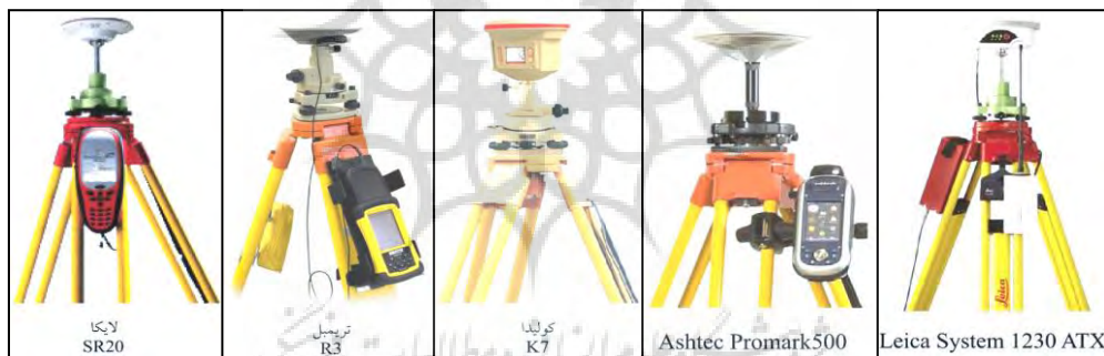
شکل ۳- ج: گیرنده‌های نقشه‌برداری تک و دو فرکانسه (مأخذ: سایت کالوب)
