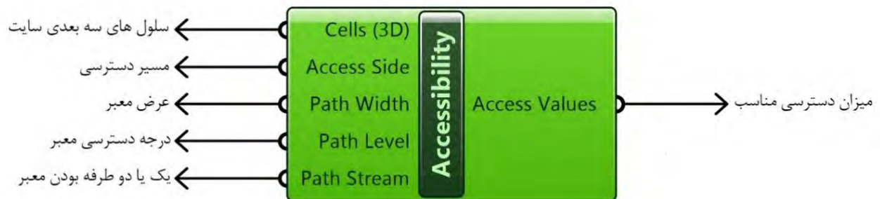
شکل ۷. الگوریتم بررسی میزان دسترسی مناسب به بستر طراحی بر اساس متغیرهای وابسته و مستقل ورودی
