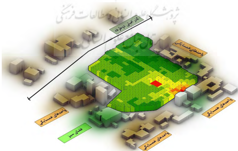
شکل ۱۱. ماتریس سه بعدی عددی میانگین به همراه رنگ. تعیین‌کننده عرصه‌بندی سایت براساس بهترین و بدترین نقاط سایت به منظور طراحی و ساخت براساس پارامترهای تأثیرگذار محیطی (نورگیری و سایه‌اندازی، آلودگی صوتی، دید و منظر و دسترسی مطلوب)
