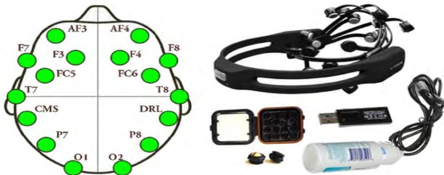
شکل ۲: تجهیزات ثبت، نام و شماره الکترودها و محل قرارگیری آنها روی سطح سر
