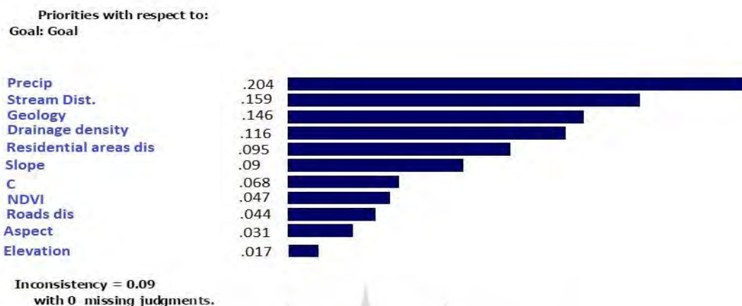
شکل ۳: وزن نهایی معیارهای منتخب موثر در سیل‌خیزی محاسبه شده در نرم‌افزار Expert Choice
