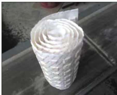
شکل ۵. BioPCM استفاده شده در دیوارها منبع: Muruganantham et al. , 2010
