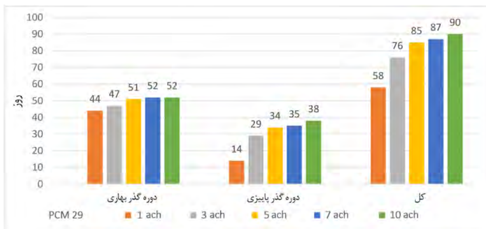
شکل ۲۱. میزان تأثیر تهویه طبیعی با نرخ تعویض هوای متفاوت بر افزایش تعداد روز دوره گذر فصلی در کل سال با میزان مصرف تا ۰/۵ kWh/روزانه، با PCM29
