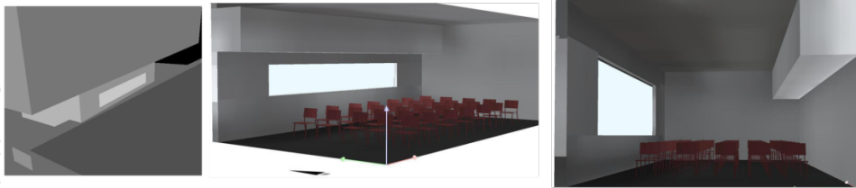
تغییر مکان کانال تاسیسات و دو برابر کردن ارتفاع پنجره
