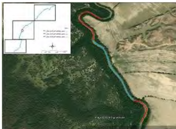
شکل ۱۰- افزایش فاصله پیچان رودها از همدیگر و مستقیم شدن مسیر رودخانه
