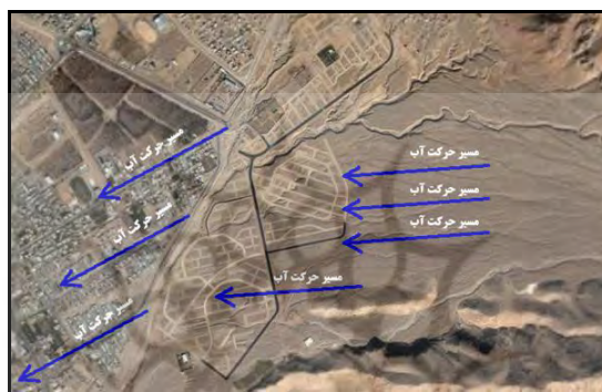
شکل ۴- جهت حرکت آب در زمین‌های واقع در شرق ساحل رود کتوئیه و مسیر احتمالی حرکت آب در هنگام طغیان در سطح شهر داراب (ماخذ Google Earth).
