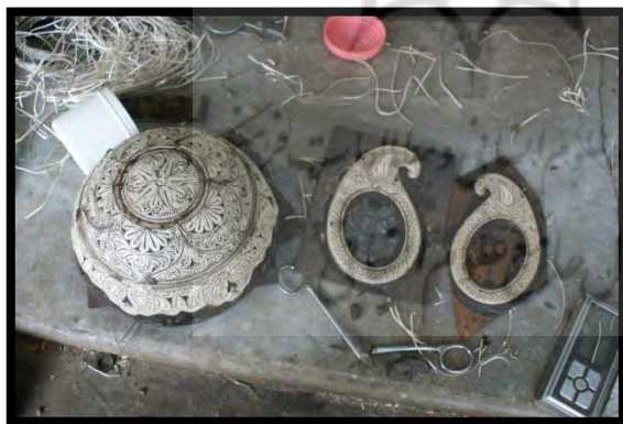
تصویر ۱۰. کاربرد موم برای نگه داشتن قطعات ریز ملیله در کنار هم (عکس نگارندگان).
