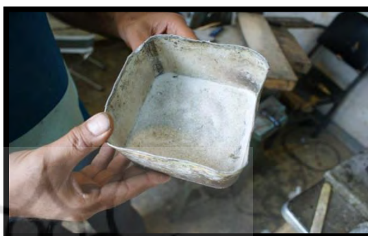
تصویر ۸. مخلوط لحیم و پودر مفرغ با پودر جوش (عکس نگارندگان).
