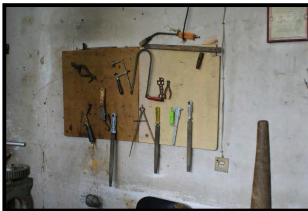
تصویر ۲. برخی از ابزارهای ملیله‌کاری (عکس نگارندگان).
