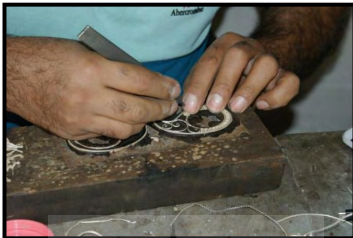
تصویر ۲۴. چگونگی نصب قطعات در روی قاب (عکس نگارندگان).
