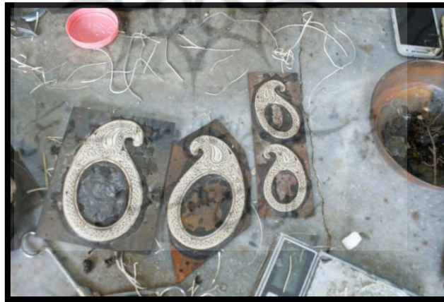
تصویر ۱۲. چگونگی قرار گرفتن قطعات بر روی قالب و لایه مومی روی آن (عکس نگارندگان).
