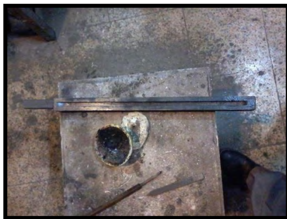
تصویر ۸. بوته ذوب نقره و قالب میله‌ای فولادی برای تبدیل نقره ذوب شده به شمش میله‌ای (عکس نگارندگان).
