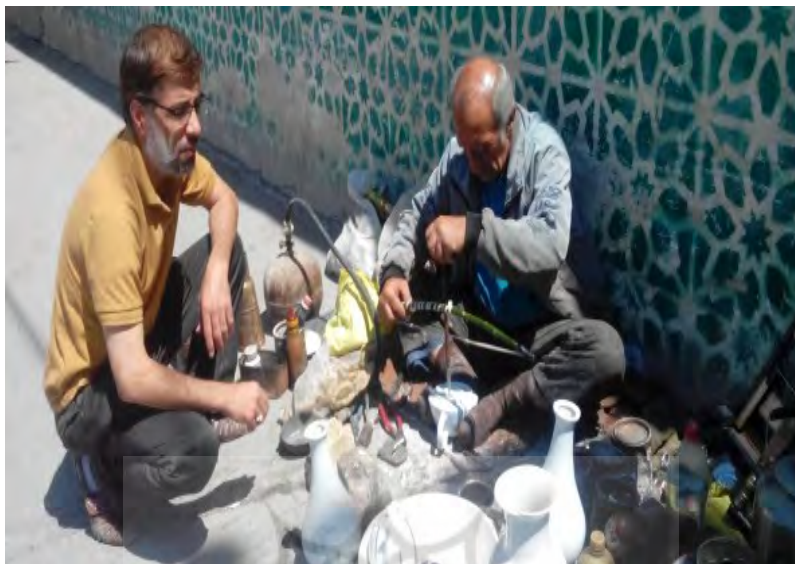
عکس ۱۳- استادکار چینی‌بندزن در حال سوراخ‌کاری قوری شکسته نگارندگان، تابستان ۱۳۹۹: محله جوی‌آباد، خمینی شهر اصفهان).
