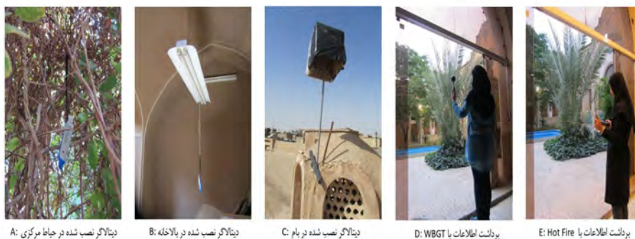
تصویر ۷- برداشت داده‌های آب و هوایی توسط دستگاه‌های اندازه‌گیری (مأخذ: نگارنده)
